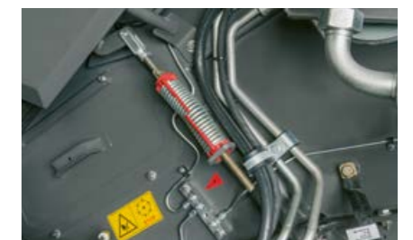
Kaikki voitelukohtat on koottu keskeisiin, selkeästi merkittyihin voitelulistoihin.
