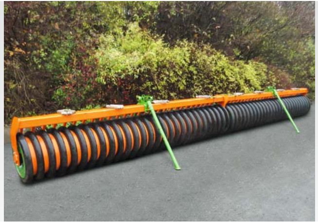
Jyrän irrottaminen ja varastointi jyränpitimen avulla
