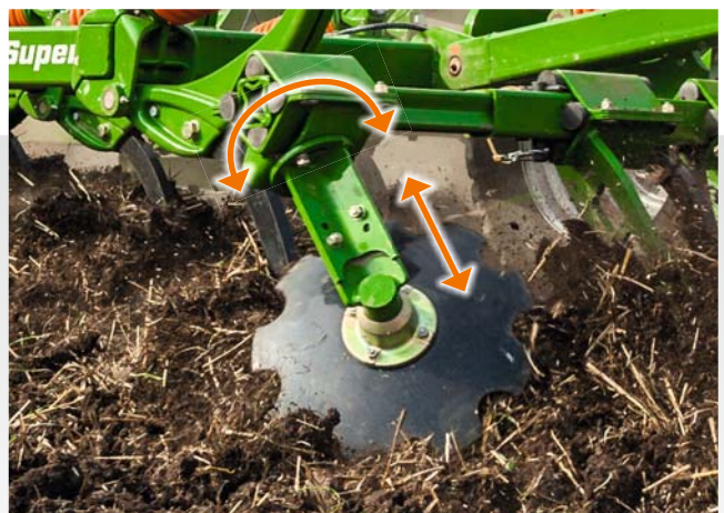
Reunaelementin korkeutta ja kallistusta on mahdollista säätää erikseen
