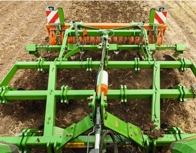
Cenius 3003 Special -koneen kolmepalkkinen rakenne
