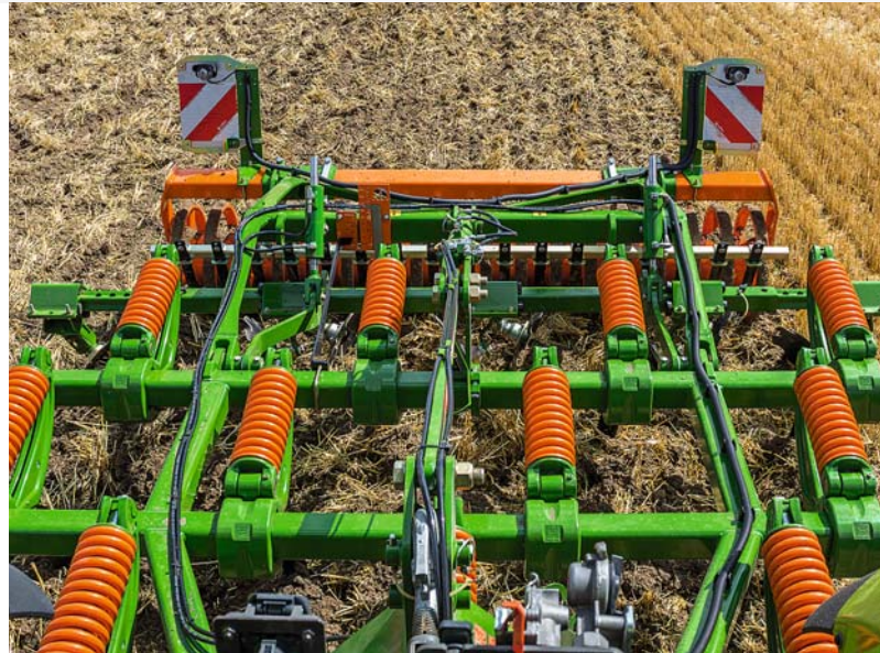
Cenius 3003 Super -koneen kolmepalkkinen rakenne
