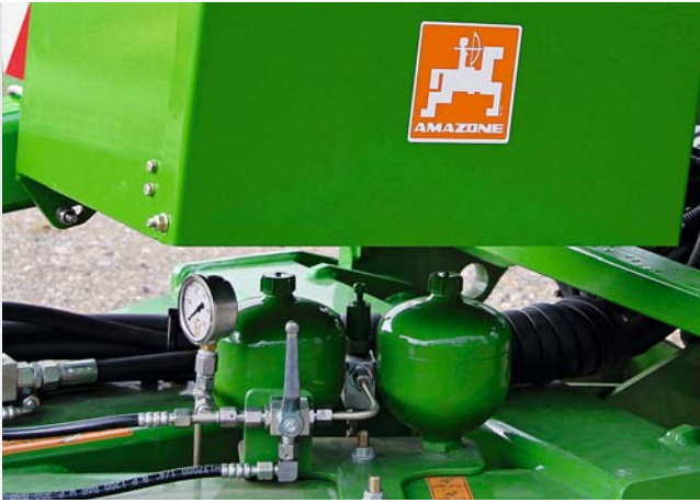
Vetokyvyn parannus ja lisävarusteena saatava Servicebox
