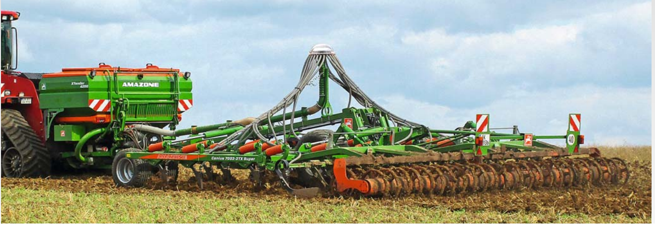
XTender 4200 ja Cenius 6003-2TX ja syöttöjärjestelmä lannoitteen levittämiseen
