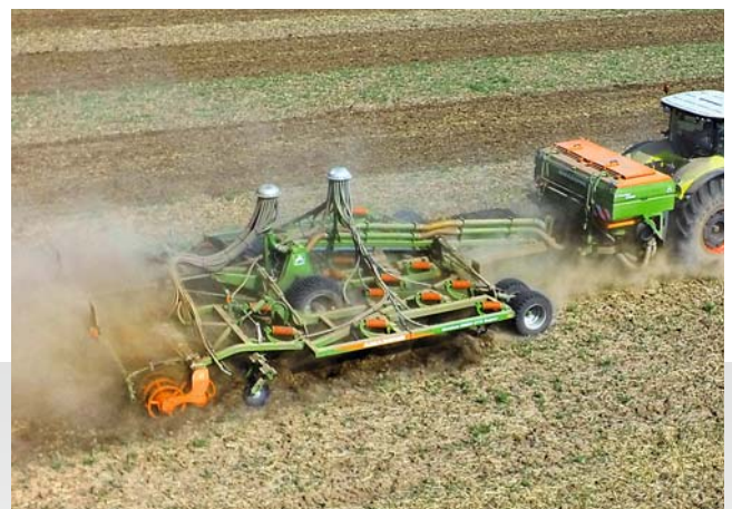
XTender 4200 ja Cenius 6003-2TX ja kaksi syöttöjärjestelmää lannoitteen ja siemenien levittämiseen
