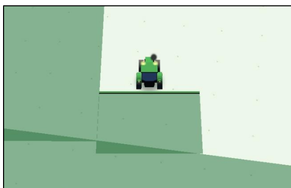
Exempel på automatisk täckning på en vändteg med ett redskap med en sektion
