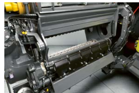
▲ Esitiivistystelot voidaan nostaa hydraulisesti huoltotöitä varten.
