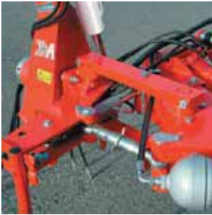
Ensimmäisen viulun hydraulinen leveyden säätö.
