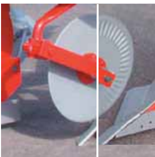
Kiekkoleikkurit voivat olla tasaisia tai uritettuja, kiinteillä tai jousitetuilla leikkurivarsilla.
