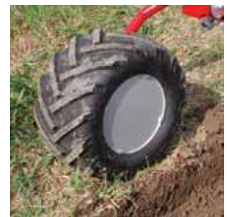
Traktorikuviaisen pyörän vannesuoja. Estää maan tarttumisen.
