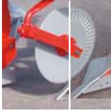
Kiekkoleikkurit ovat saavissa sileinä tai hammastettuina; joustavina tai kiinteinä ja 450 tai 500 mm halkaisijalla.
