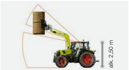
Matalakatto-ohjaamo lasikattoluukulla: Alituskorkeus alk. 2,50 m.
