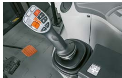
Myös FLEXPILOT hallintaventtiilien hallinnalla on monitoimikahva mukavasti ja turvallisesti käsillä.
