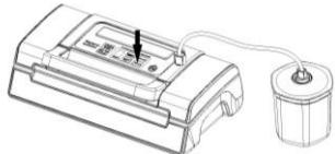
4. Avlägsna slangen från burken och maskinen när packningen är färdig.
