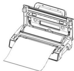
7. Packningen är nu färdig. Öppna locket genom att lyfta handtaget och tag bort den färdigpackade påsen.**Fig. 4**
