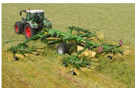
Neliroottorinen keskikarhotin Swadro 1400 ja 1400 Plus Säädettävä työleveys 11,00–13,50 m
