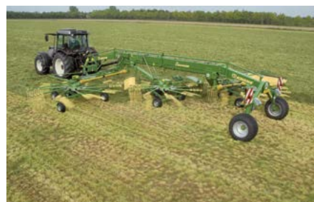
Kaksiroottorinen sivukarhotin Swadro 1010 Työleveys 9,70 m
