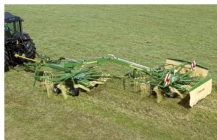
Kaksiroottorinen sivukarhotin Swadro 710/26 T Työleveys 6,20 m tai 2 x 3,40 m
