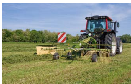
Nostolaitteeseen kytkettävä yksiroottorinen karhotin Työleveys 3,50–4,60 m
