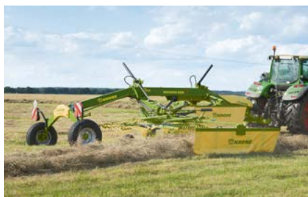
Kaksiroottorinen sivukarhotin Swadro TS ja TS Twin Työleveys 6,20–8,20 m
