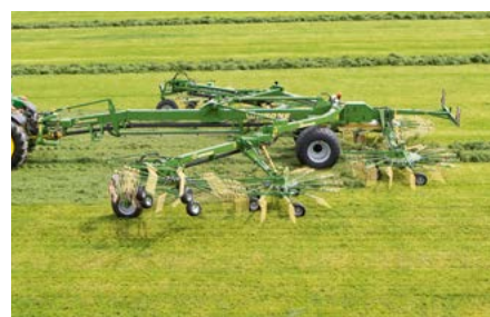
Kuusiroottorinen keskikarhotin Swadro 2000 Säädettävä työleveys 11,00–19,00 m
